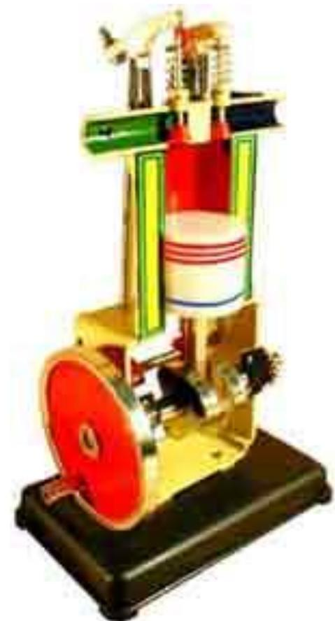
**Повторяющийся рабочий цикл двигателя состоит из четырех процессов (тактов): а) впуск, б) сжатие, в) рабочий ход, г) выпуск.**
