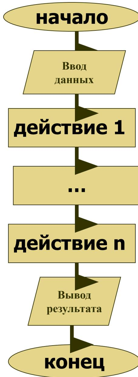
**Линейный алгоритм** – это алгоритм, в котором команды выполняются последовательно одна за другой.
