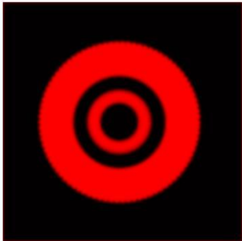
Дифракционная картина от круглого отверстия
