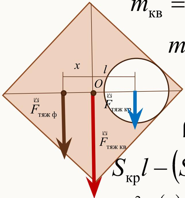
$$S_{\text{кр}} l - (S_{\text{кв}} - S_{\text{кр}})x = 0 \quad (5)$$
