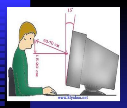
Монитор необходимо установить на такой высоте, чтобы центр экрана был на 15-20 см ниже уровня глаз, угол наклона до  $15^0$  (т.е., примерно, верхняя часть экрана должна находиться на уровне глаз (при работе в очках с бифокальными линзами — ниже уровня глаз). Экран монитора должен находиться от глаз пользователя на оптимальном расстоянии 60-70 см, но не ближе 50 см с учетом размеров алфавитноцифровых знаков и символов. Не располагайте рядом с монитором блестящие и отражающие свет
