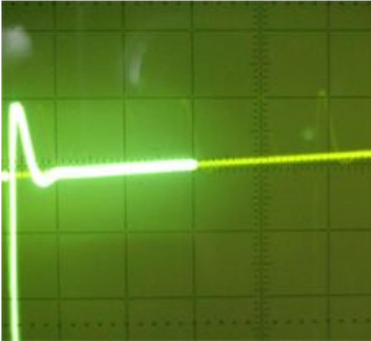
$C = 16 \text{ мкФ}$ ,  $R \text{ кат} = 120 \text{ Ом}$ ,  $L = 0,99 \text{ Гн}$
