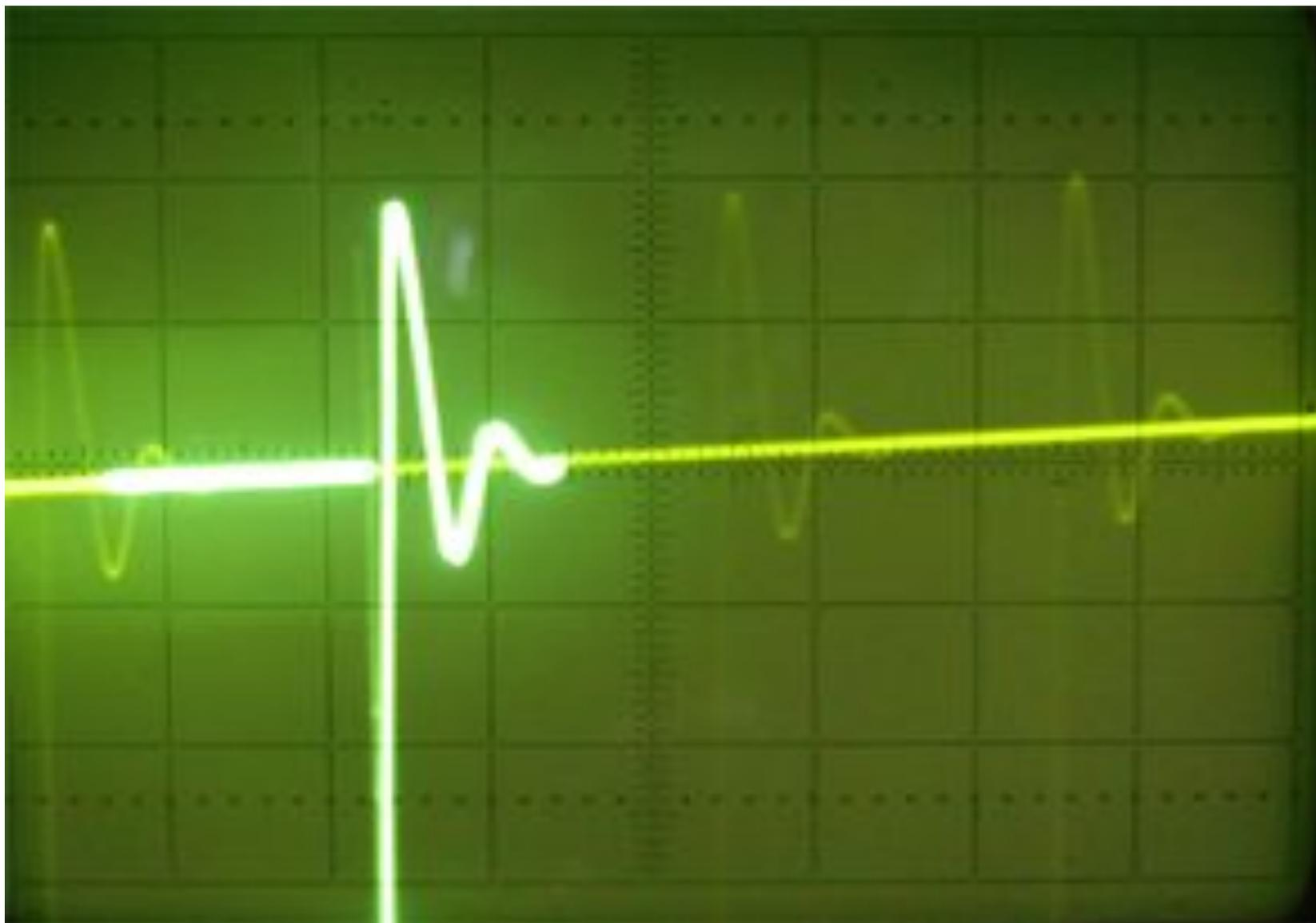
$C = 16 \text{ мкФ}$ ,  $R \text{ полн.} = 70 \text{ Ом}$ ,  $L = 0,99 \text{ Гн}$
