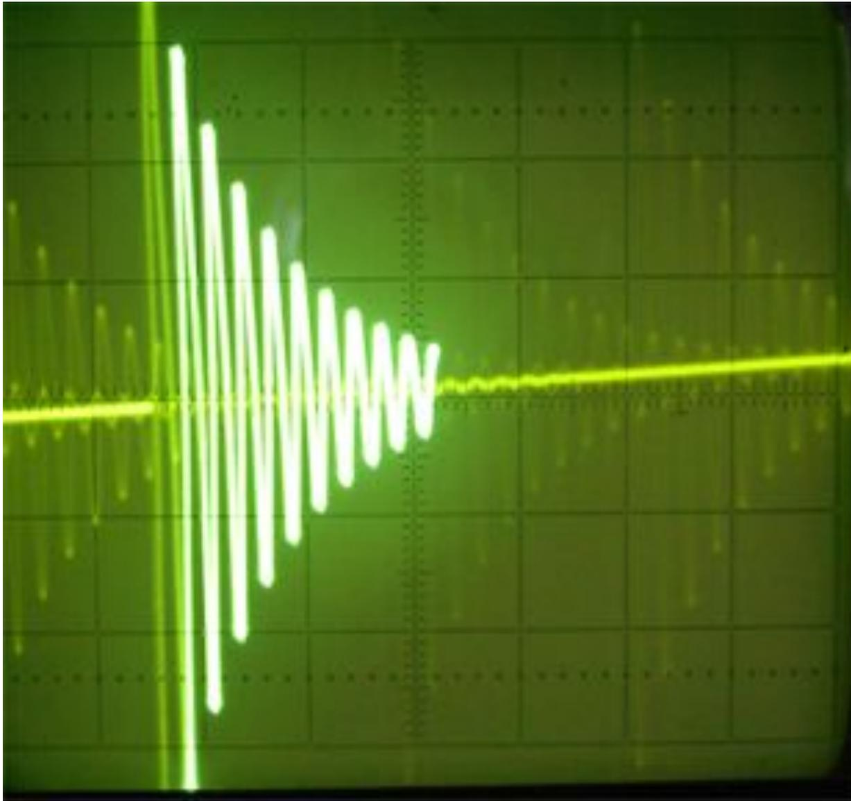
$C = 4 \text{ мкФ}$ ,  $R_{\text{кат}} = 20 \text{ Ом}$ ,  $L = 0,99 \text{ Гн}$
