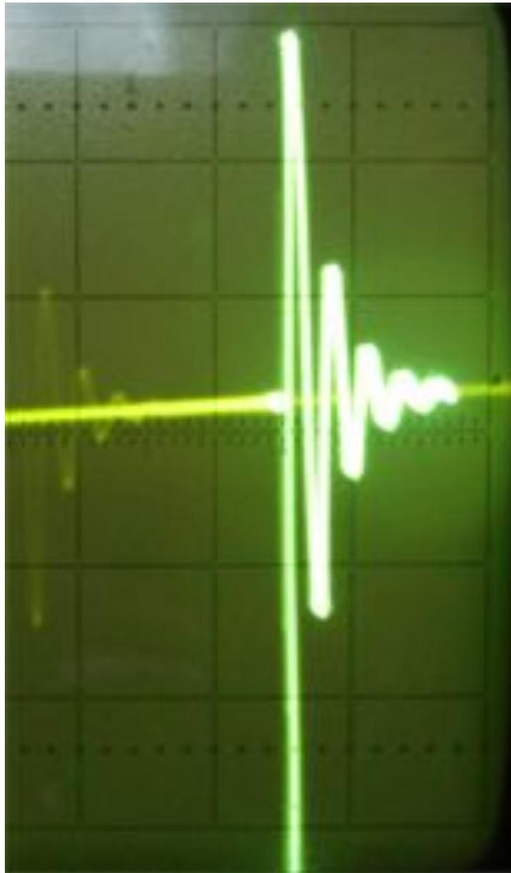
$C = 4 \text{ мкФ}$ ,  $R \text{ полн.} = 120 \text{ Ом}$ ,  $L = 0,99 \text{ Гн}$
