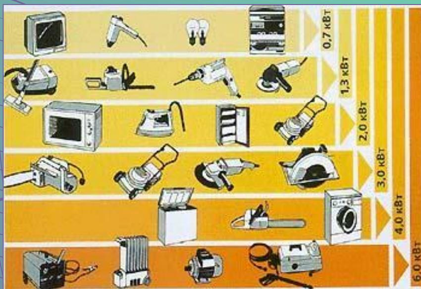
Источниками электромагнитных полей являются все бытовые приборы, работающие с использованием электрического тока. При этом уровень излучения изменяется в широчайших пределах в зависимости от модели, устройства прибора и конкретного режима работы. Также уровень излучения сильно зависит от потребляемой мощности прибора – чем выше мощность, тем выше уровень электромагнитного поля при работе прибора. Напряженность электрического поля вблизи электробытовых приборов не превышает десятков В/м.
