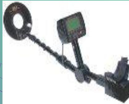
Вышеприведенная технология обусловила состав металлодетектора: он состоит из четырех основных блоков: антенны (иногда излучающая и принимающая антенны различаются, а иногда - это одна и та же антenna), электронного обрабатывающего блока, блока вывода информации (визуальной - ЖК-дисплей или стрелочный индикатор и аудио - динамика или гнезда для наушников) и блока питания.
