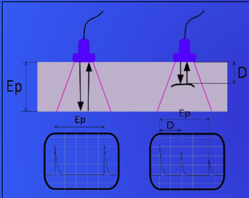
Ультразвук применяется для обнаружения в литых деталях различных дефектов - трещин, воздушных полостей и т.д. Этот метод называется ультразвуковой дефектоскопией. Он заключается в том, что на исследуемую деталь направляется поток коротких ультразвуковых сигналов, которые отражаются от находящихся внутри нее неоднородностей и, возвращаясь, попадают в приемник. В тех местах, где дефектов нет, сигналы проходят сквозь деталь без существенного отражения и соответственно не регистрируются приемником.
