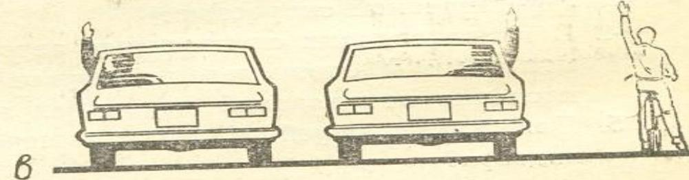
а- сигнал поворота налево; б- сигнал поворота направо; в- сигнал торможения.
