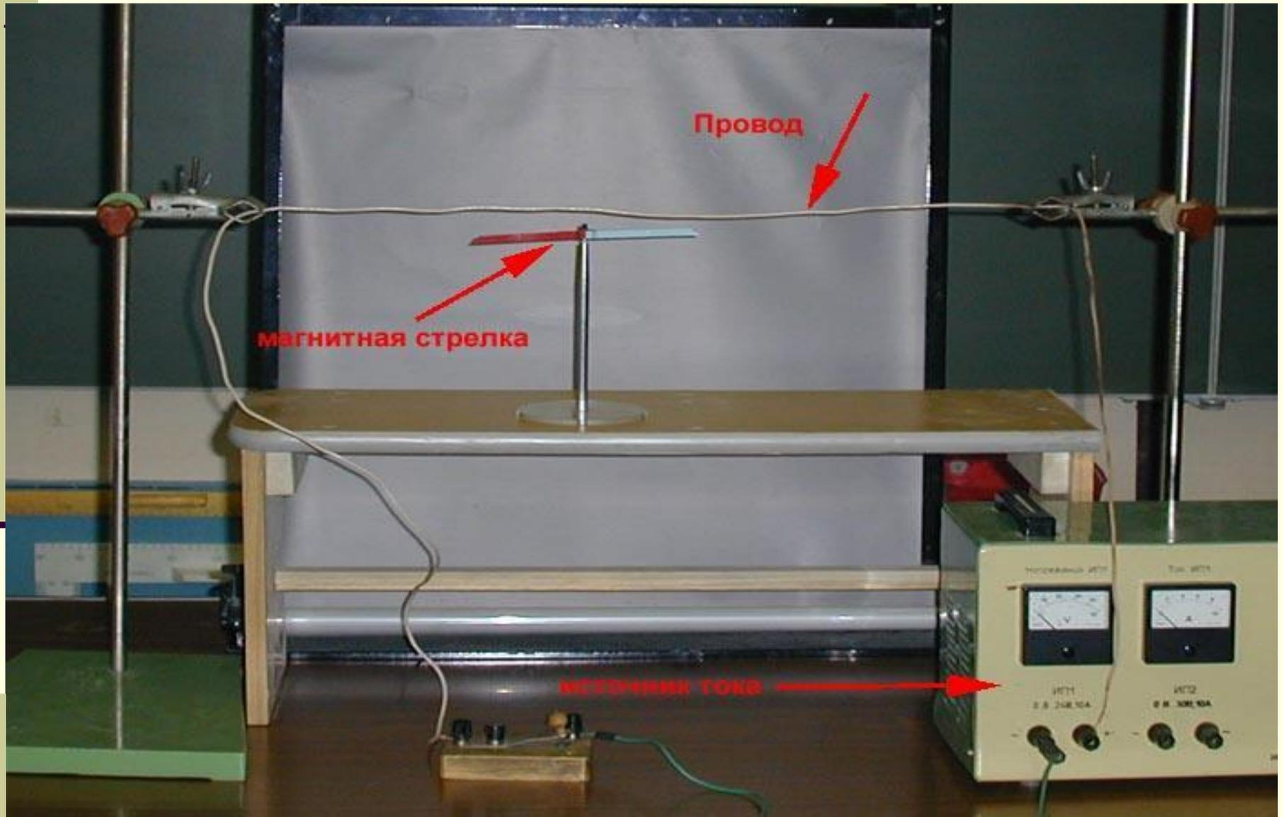
**Выполненный опыт наводит на мысль о существовании вокруг проводника с электрическим током **магнитного поля**. Оно и действует на магнитную стрелку , отклоняя ее.**
