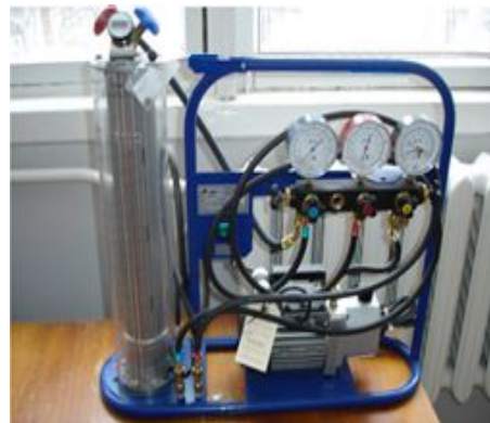
Заправочно-измерительная станция с дозиметром и вакуум насосом
