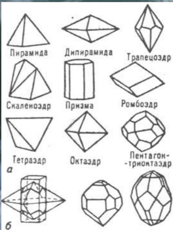
**Изменение формы одного и того же кристалла при изменении различных факторов.**
