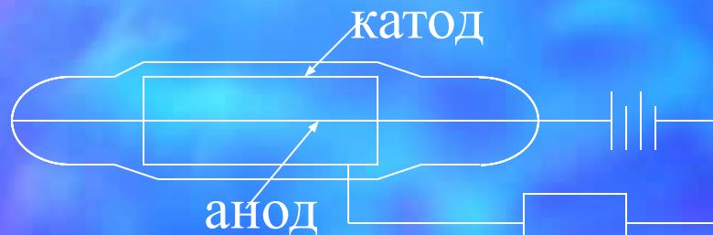
Счетчик состоит из закрытой трубки, по оси которой натянута, струна (А), а стенки покрыты тонким проводящим слом (К). Трубка заполнена аргоном.
