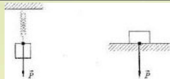
Вес – это суммарная сила упругости, действующая при наличии силы тяжести на все опоры и подвесы:
