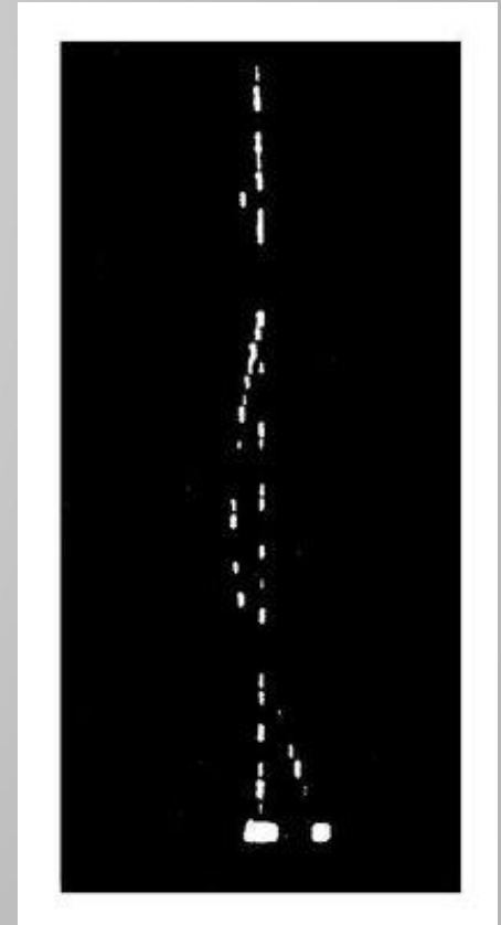
Трек частицы в узкоззорной искровой камере
