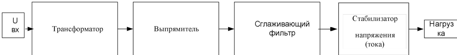
**Трансформатор** предназначен для гальванической развязки питающей сети и нагрузки и изменения уровня переменного напряжения. Обычно трансформатор является понижающим.
