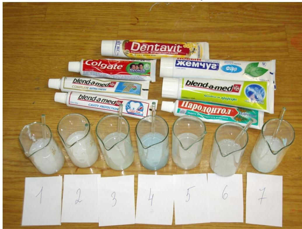
Фильтровали, засекая время фильтрации; в фильтре определяли наличие ионов  $\text{Ca}^{2+}$ ,  $\text{PO}_4^{3-}$ ,  $\text{F}^-$ .
