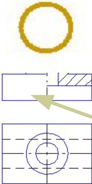
1. Разрез на чертеже располагают справа от оси симметрии или под ней.
