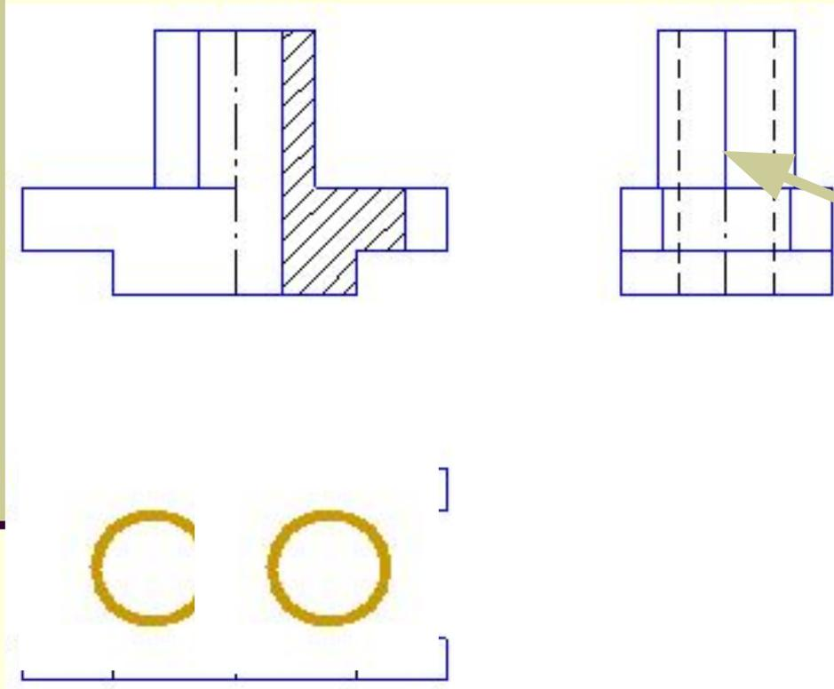
Возможно совмещение части вида и части разреза, потому что контур детали совпал с осью симметрии.
