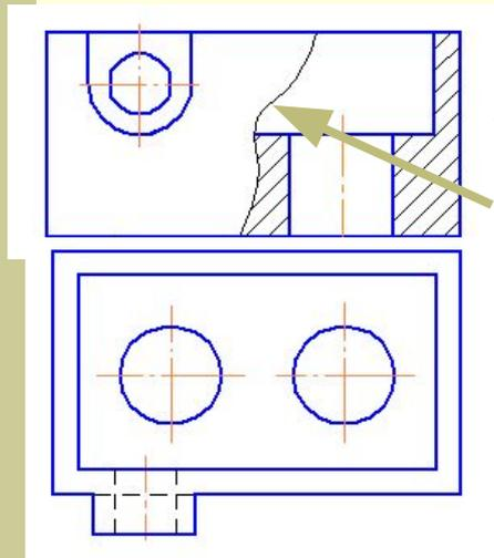
Линия, разделяющая часть вида и часть разреза – сплошная волнистая линия.
