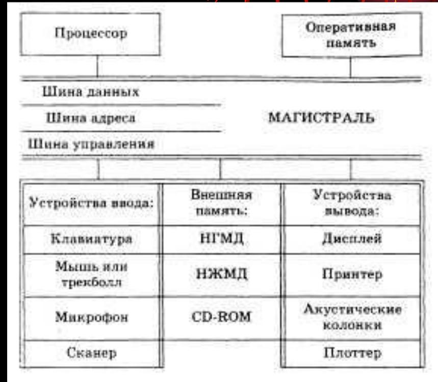
Схема магистрально-модульного принципа построения ПК
