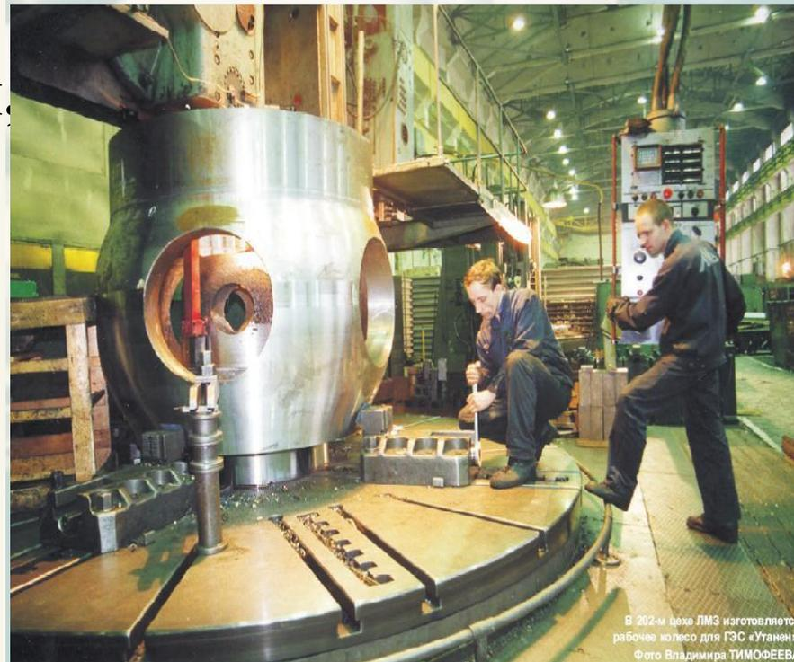
В 202-м цехе ЛМЗ изготавливается рабочее колесо для ГЭС «Утанен».
