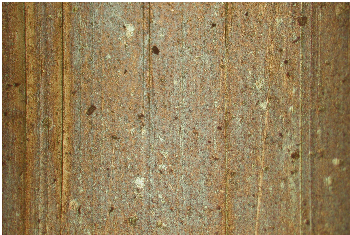
Рис. 1. Поверхность дорожки качения шарикового подшипника коробки передач, а - без обработки, б - после обработки ГМТ (примерно 10000 км пробега автомобиля)
