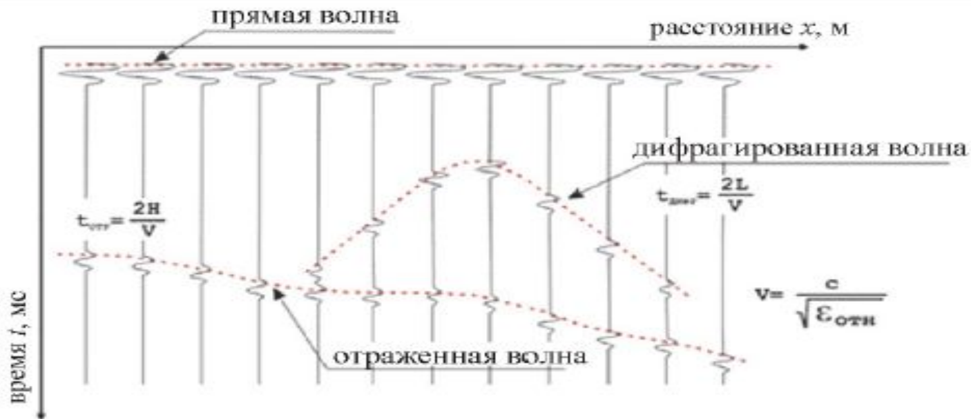
Рис. 6.6 Схема образования дифрагированной электромагнитной волны от трубы, залегающей на глубине и волны, отраженной от границы раздела сред с разными диэлектрическими проницаемостями: глубинный и временной разрезы
