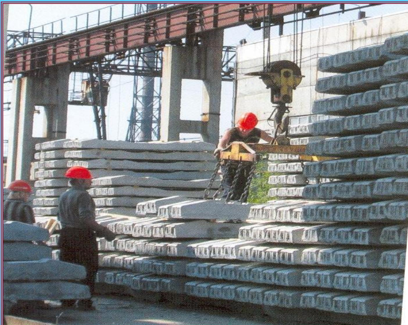
2000 год. **Завод ЖБШ**, где выпускают железобетонные шпалы для нужд РЖД.
