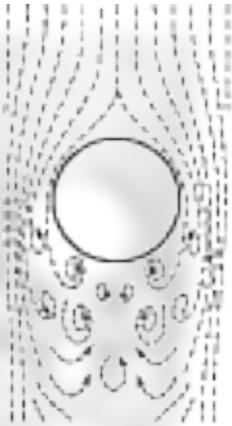
Когда пузырек лопается, вся окружающая его жидкость устремляется внутрь, и возникает кольцевая волна. Смыкаясь, она выбрасывает вверх столбик воды.
