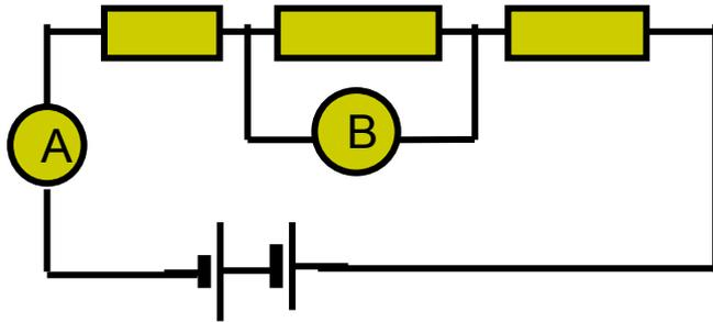
В цепь последовательно включены три сопротивления  $R_1 = 4 \text{ Ом}$ ,  $R_2 = 6 \text{ Ом}$ ,  $R_3 = 10 \text{ Ом}$ . Какую силу тока показывает амперметр, если на вольтметре  $1,5 \text{ В}$ ?
