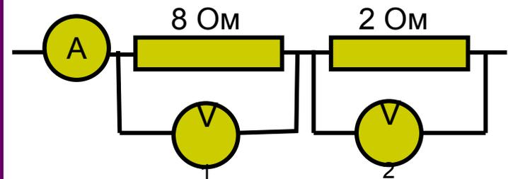
Вольтметр  $V_1$  показывает  $12 \text{ В}$ . Каковы показания амперметра и второго вольтметра?
