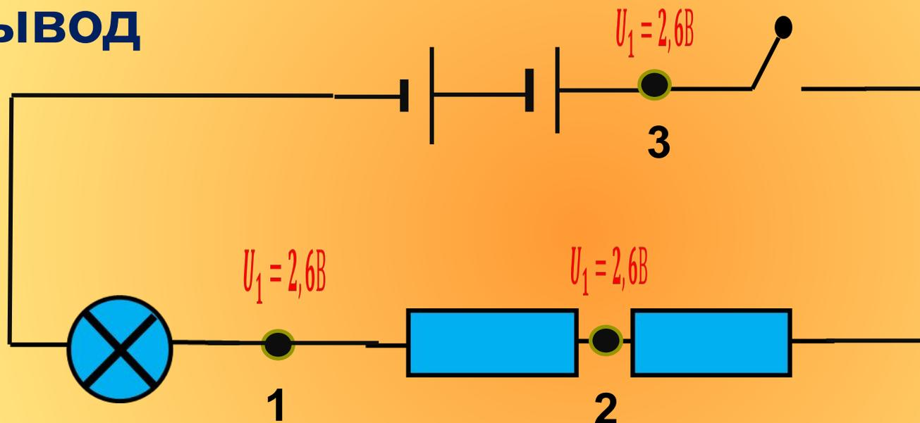
**Вывод:** сила тока в различных участках цепи при последовательном соединении **одинаковая**
