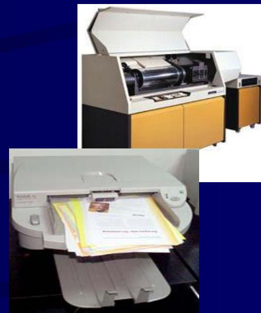
В барабанных сканерах оригинал закрепляется на поверхности из прозрачного материала цилиндрической формы (барабане), которая укреплена на массивном основании, которое обеспечивает необходимую устойчивость. Барабан вращается с высокой скоростью (от 300 до 1350 оборотов в минуту), а находящийся рядом с ним сканирующий датчик через
