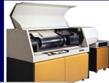
Сканер, в котором оригинал закрепляется на вращающемся барабане, а для сканирования используются фотоэлектронные умножители. При этом сканируется точечная область изображения, а сканирующая головка движется вдоль барабана на очень маленьком расстоянии от оригинала.
