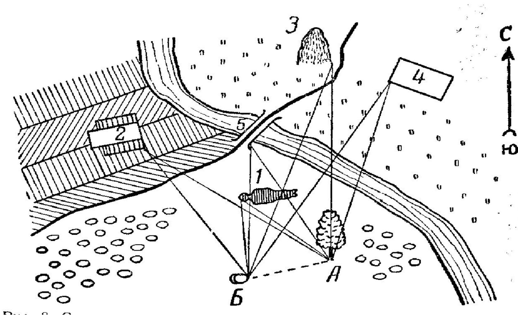
А — исходная точка; Б — первый из предметов, наносимых на план; АБ — база съемки 1, 2, 3, 4, 5 — предметы, на которые производилось визирование из точек А и Б
