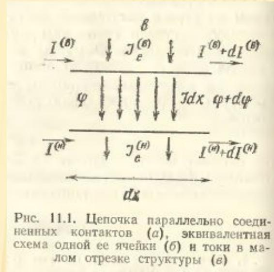
Рис. 11.1. Цепочка параллельно соединенных контактов (а), эквивалентная схема одной ее ячейки (б) и токи в малом отрезке структуры (в)
