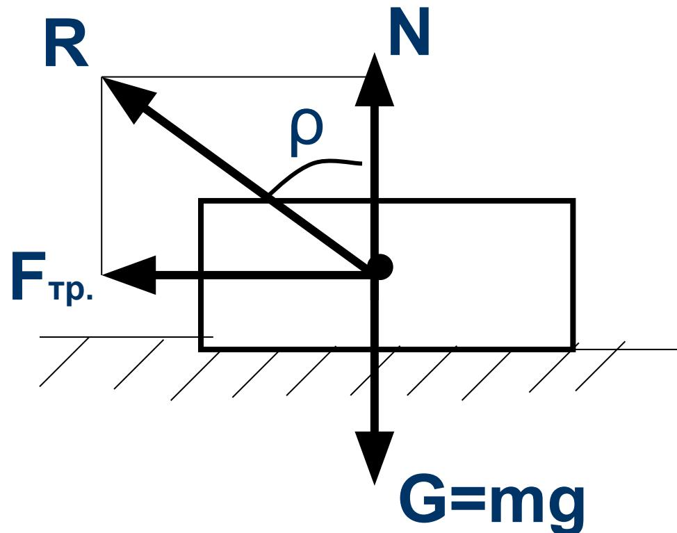
Угол трения - это угол образованный направлением суммарной реакции  $R$  с направлением нормальной реакции  $N$
