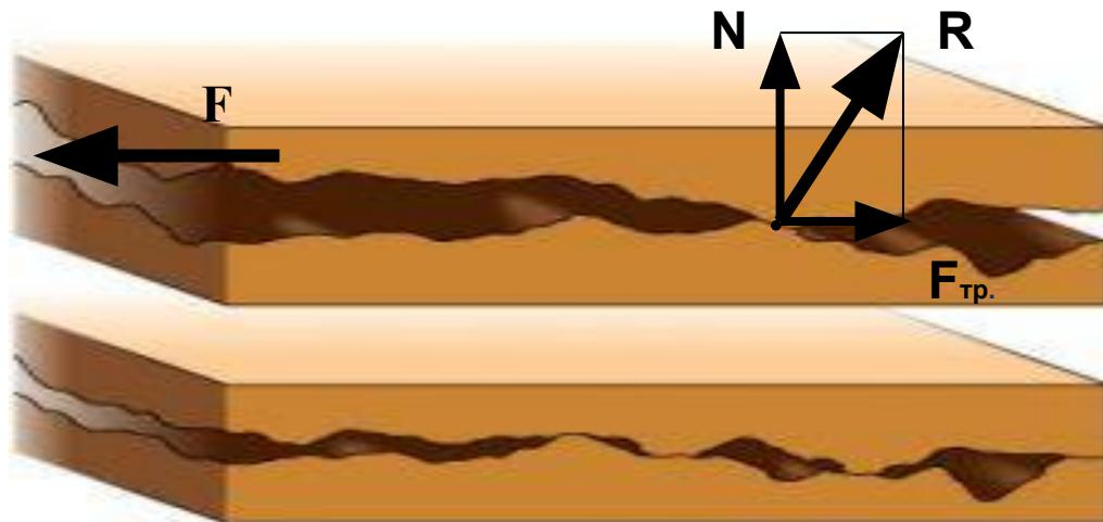
Схематическое изображение места контакта скользящих поверхностей при малой (верх) и большой (низ) сжимающей их силе.
