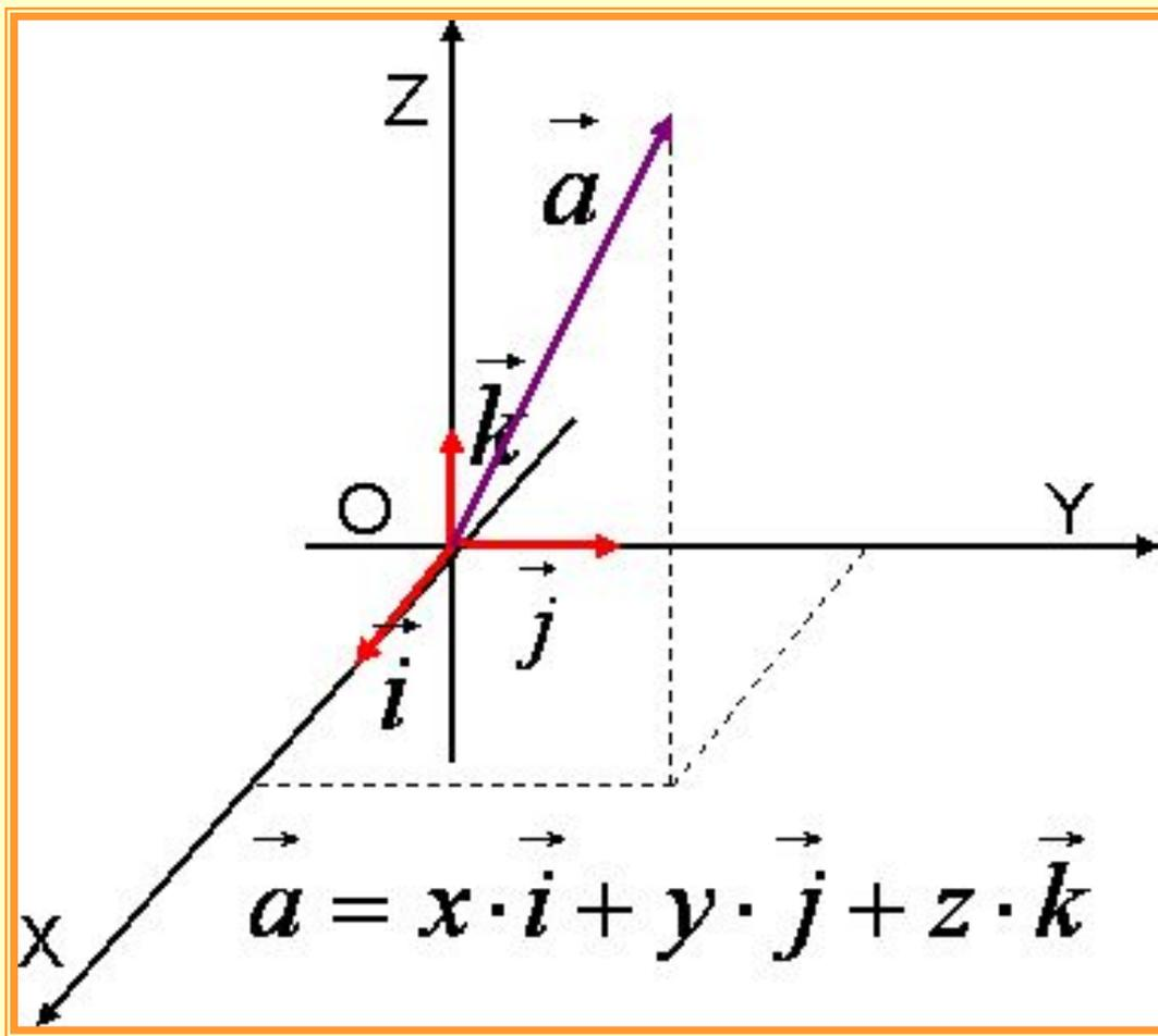
Определение. Вектора  $\vec{i}$ ,  $\vec{j}$ ,  $\vec{k}$  называются координатными векторами. Эти векторы некопланарны, а значит, любой вектор  $\vec{a}$  можно разложить по координатным векторам:  $\vec{a} = x \vec{i} + y \vec{j} + z \vec{k}$ .
