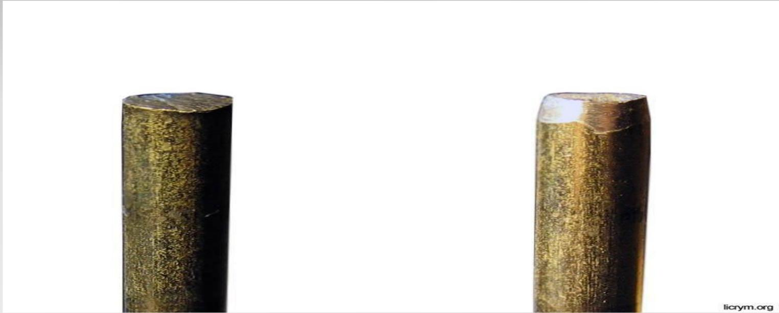
Для того что бы нарезать резьбу возьмем стержень из мягкой стали. Наружный диаметр стержня соответствует наружному диаметру резьбы. Например если нам нужна резьба М3 то мы должны взять стержень с диаметром 3 мм, и взять плашку на М3.
