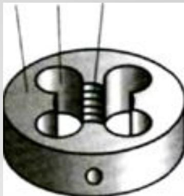
Наружную резьбу на стержне получают с помощью плашек. Их закрепляют в приспособлениях — плашкодержателях
