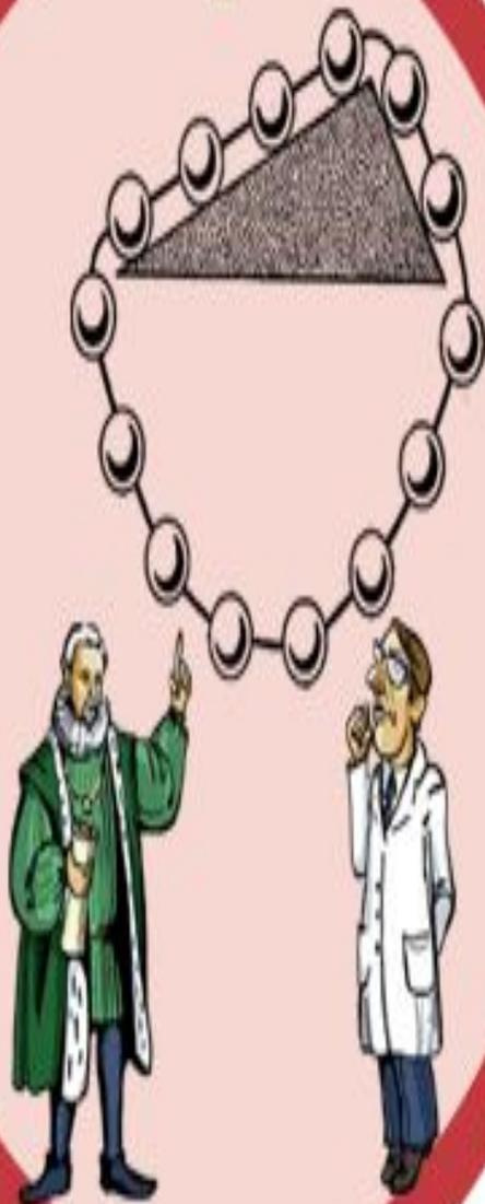
**Идея изобретателя:** Через трехгранную призму перекинута цепь из 14 одинаковых шаров. Слева четыре шара, справа — два. Остальные восемь шаров уравнивают друг друга. Следовательно, цепь придет в вечное движение против часовой стрелки.
