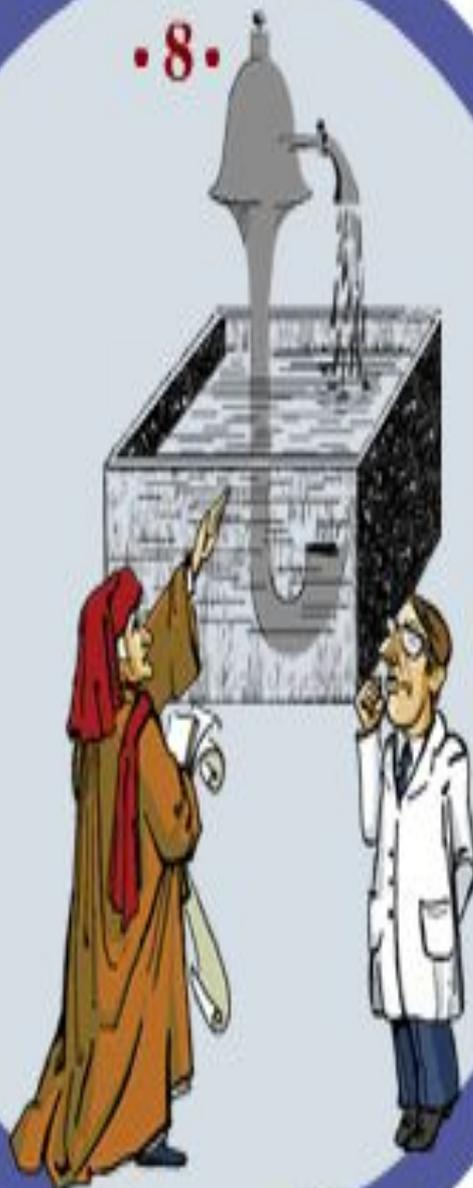
**Идея изобретателя:** Давление воды в большом баке должно постоянно выжимать воду по трубе в верхнюю емкость.
