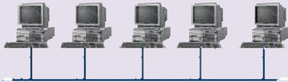
**Шина** - топология, в которой все компьютеры соединены вдоль одного сегмента кабеля. В качестве передающей среды используется коаксиальный кабель. Данные от передающего узла (компьютера) распространяются в обе стороны по шине. Информация поступает на все узлы, но принимает сообщение только тот, кому они адресованы.
