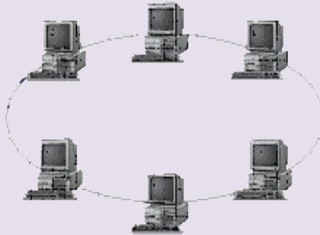
**Кольцо**-топология, в которой все компьютеры подсоединены вдоль сегмента кабеля, замкнутого в кольцо. Информация по кольцу передается от узла к узлу. Принимающий узел распознает и получает только адресованные ему сообщения. Само кольцо в современных сетях скрывается внутри маленького устройства, который называется модуль.
