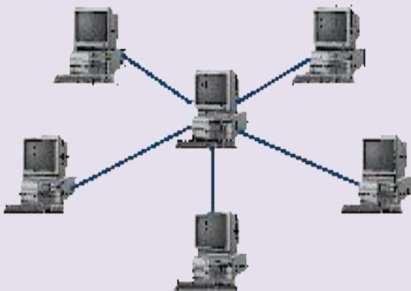
**Звезда** - такая топология, в которой все компьютеры подсоединены к сегментам, исходящим из одной точки – центрального узла. Вся информация передается через центральный узел. Эта конфигурация наиболее популярна для современных сетей. Связующим звеном такой сети является концентратор сети – хаб или коммутатор (свитч).
