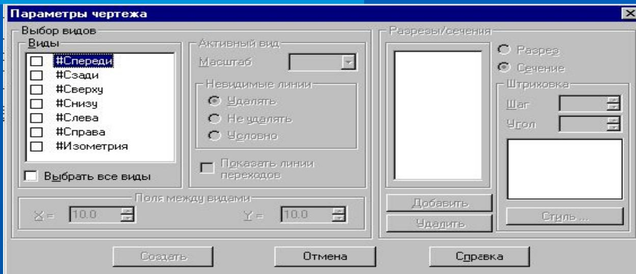
Этот диалог появляется на экране после вызова команды Создать заготовку для чертежа. В нем можно настроить параметры создаваемых в чертеже детали проекций, разрезов и сечений.
