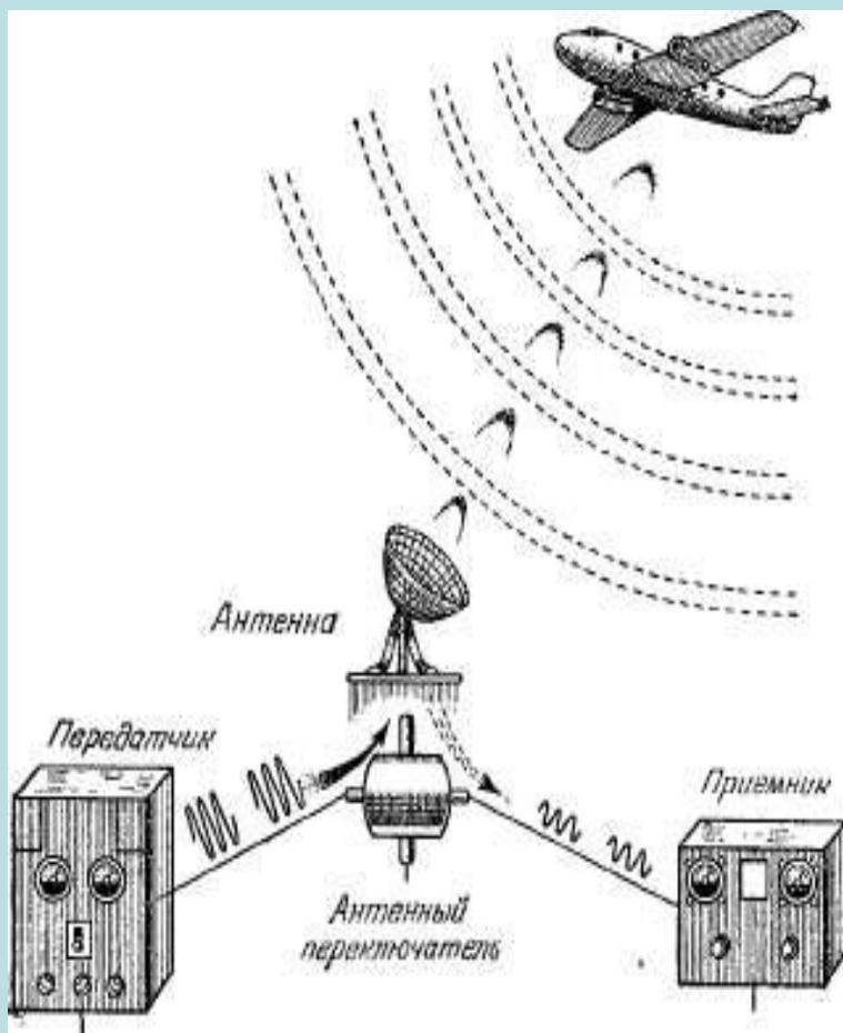
Обнаружение и определение местоположения различных объектов с помощью радиоволн.
