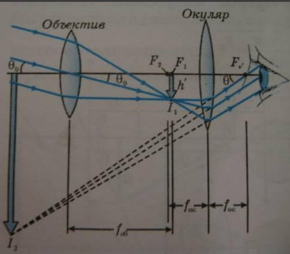
Телескоп-рефрактор содержит два основных узла: линзовый объектив и окуляр. Объектив создаёт действительное уменьшенное обратное изображение бесконечно удалённого предмета в фокальной плоскости. Это изображение рассматривается в окуляр как в лупу. В силу того, что каждая отдельно взятая линза обладает различными aberrациями, обычно используются сложные объективы. Такие объективы представляют собой выпуклые и вогнутые линзы, составленные и склеенные с тем, чтобы минимизировать aberrации.
