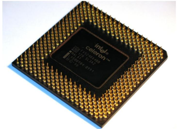
Поколения процессоров отличаются друг от друга скоростью работы, архитектурой, исполнением, внешним видом. Одна из основных характеристик – **тактовая частота**.
