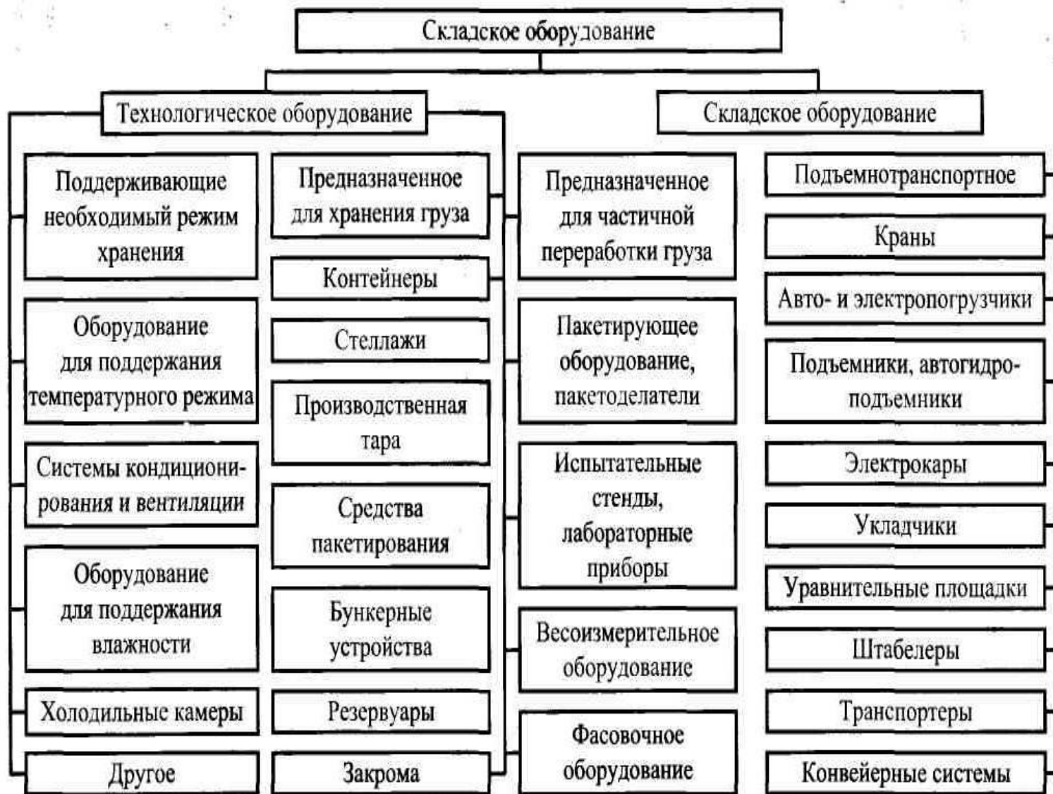
Рис. 4.1. Классификация складского оборудования
