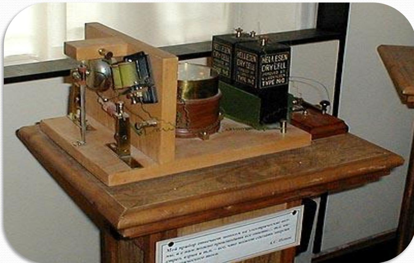
Модель простейшего телеграфного аппарата на аккумуляторах Геттесна. В центре — линза, в правой части — три аккумулятора Геттесна, в левой — звонок. Внизу — клавиатура.
