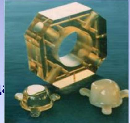
Получают их, вводя в состав стекломассы частичек металлов (центры кристаллизации).
