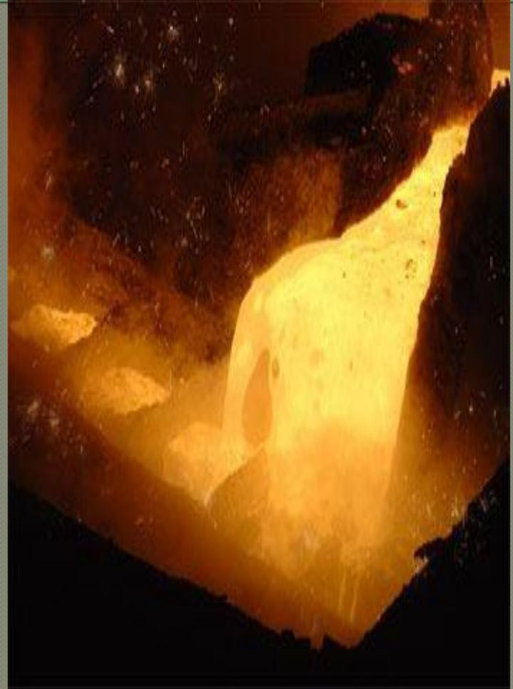
**Высокопрочный чугун** имеет графитные включения шаровидной формы, содержит 0,03—0,07% магния.
