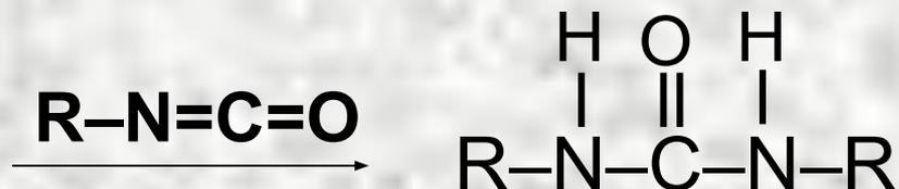
Эта реакция является завершающей стадией широко распространенного процесса получения пенопластов (в частности на основе полиуретана), особенно в месте их применения (например, при закладке слоя пенопласта между стенами здания, заделки трещин).
