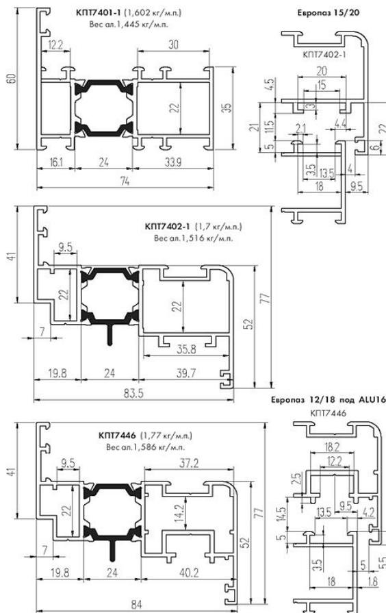
Все профили системы КПП74 сконструированы по трехкамерному принципу. Для создания терморазрыва используется термовставка шириной 24 мм из полиамида. Толщина конструкции - 74 мм. Система насчитывает около 30 "теплых" и 20 "холодных" профилей, что позволяет изготавливать "теплые" витражи, окна, балконные двери и другое.
