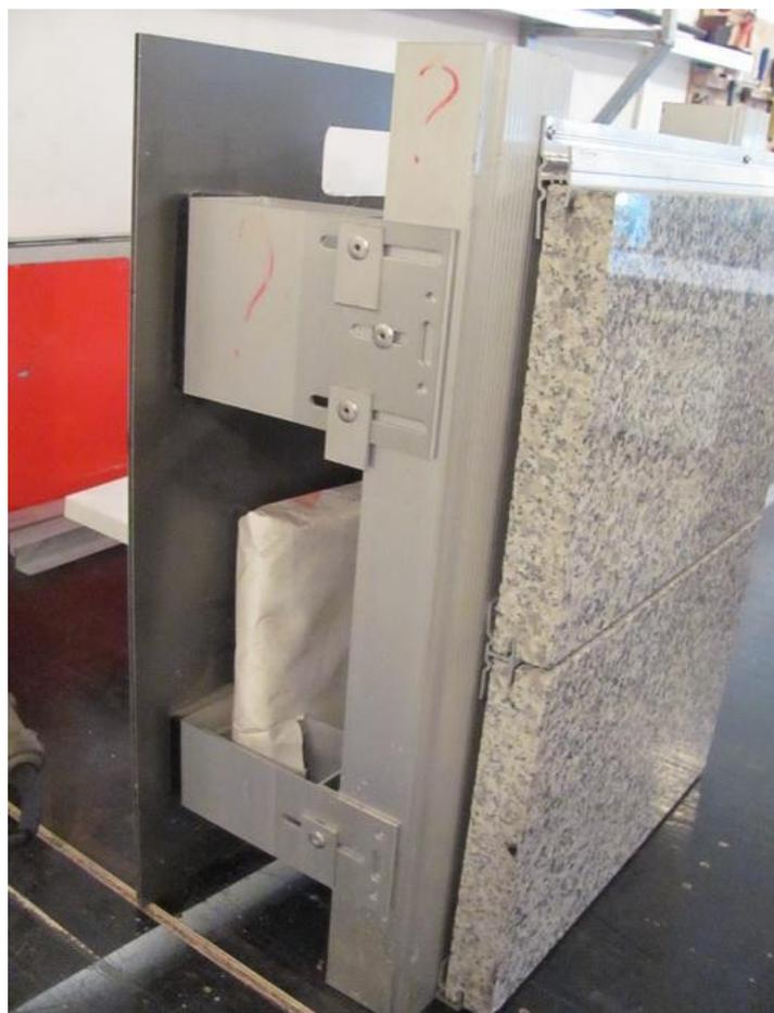
Навесные вентилируемые фасады активно используются в строительстве и реставрации зданий различного назначения. Вентилируемый воздушный промежуток снижает также и теплопотери. Такие фасады позволяют защитить здание от агрессивных условий окружающей среды и значительно улучшить внешний вид здания. В результате чего из ограждающей конструкции в окружающую среду удаляется атмосферная и внутренняя влага.
