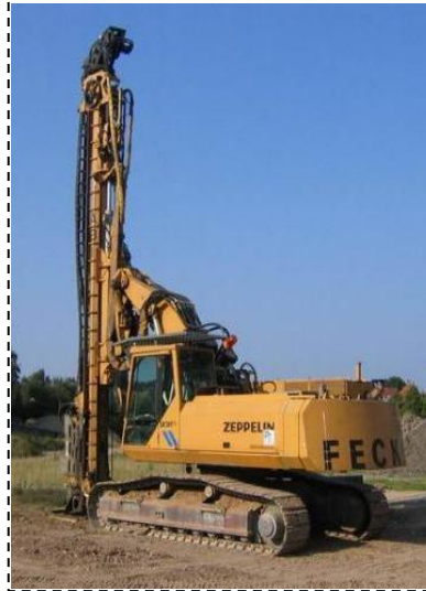
Буровая установка Zeppelin ZR28T
