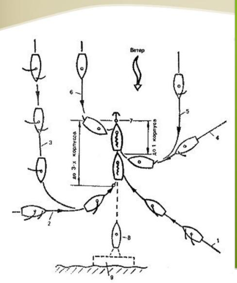
Выбор места якорной стоянки зависит от ее цели. При отстое судна от шторма во внимание принимают только вопросы обеспечения безопасности судна. При постановке судна на якорь для проведения погрузочно-разгрузочных работ и высадки пассажиров судно ставят возможно ближе к порту (берегу), чтобы обеспечить скорейшую выгрузку. Во всех случаях принимают все меры предосторожности для безопасности судна. Если суда оказываются на незащищенном рейде, они должны менять место стоянки в зависимости от погоды
