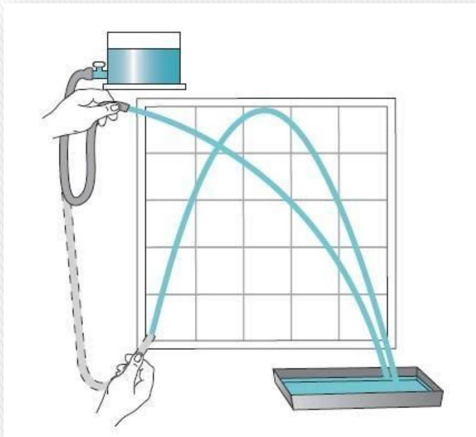
Траекторию движений тел можно наглядно изучить в простом опыте. Сосуд, наполненный водой, помещают на некоторой высоте над столом. Его соединяют резиновой трубкой с наконечником, снабжённым краном. Выпускаемые струи воды показывают траектории частиц воды.
