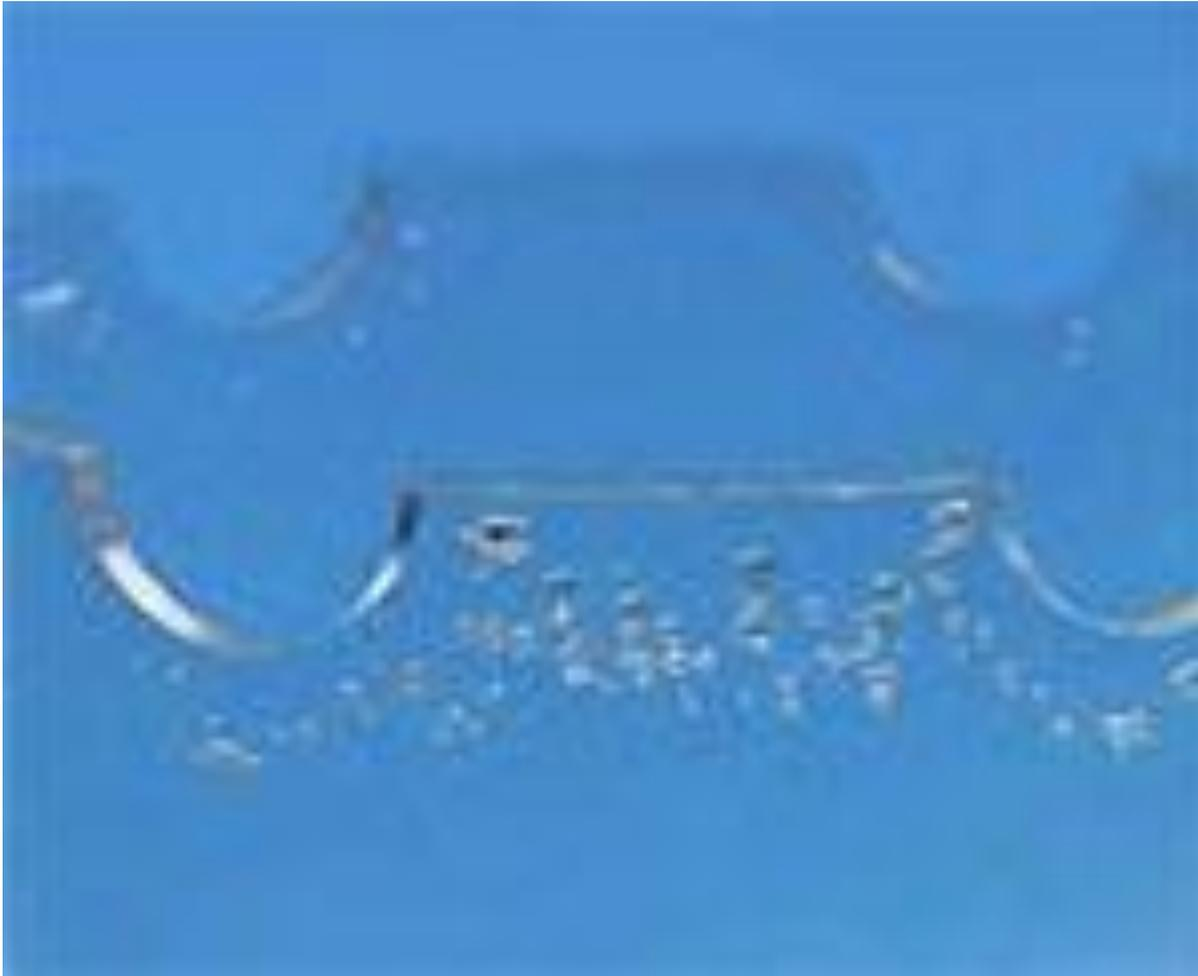
В большинстве случаев внешне неразличимы, за исключением прозрачных материалов. Детали, обычно толстостенные, у которых были выявлены полости путем разрезания
