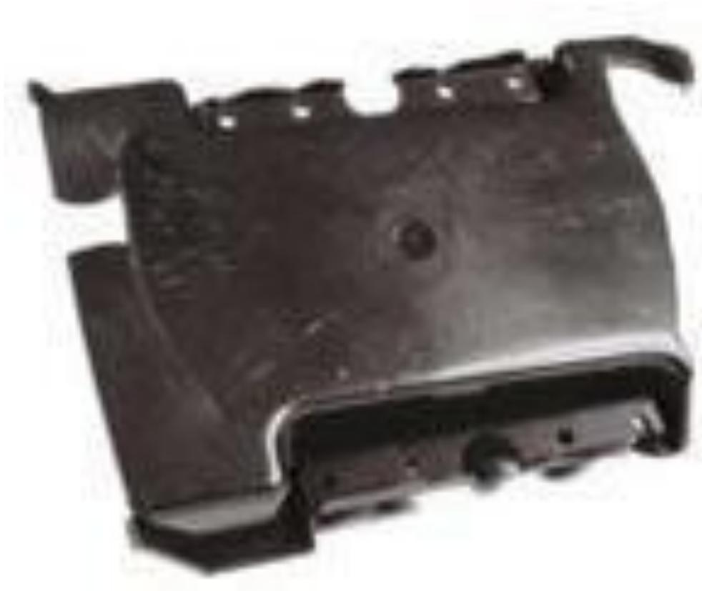
Большей частью продолговатые, серебристые свилы на поверхности в виде буквы U имеют место в направлении течения потока. Лепешка, выдавленная из цилиндра, вспенена и содержит вздутия
