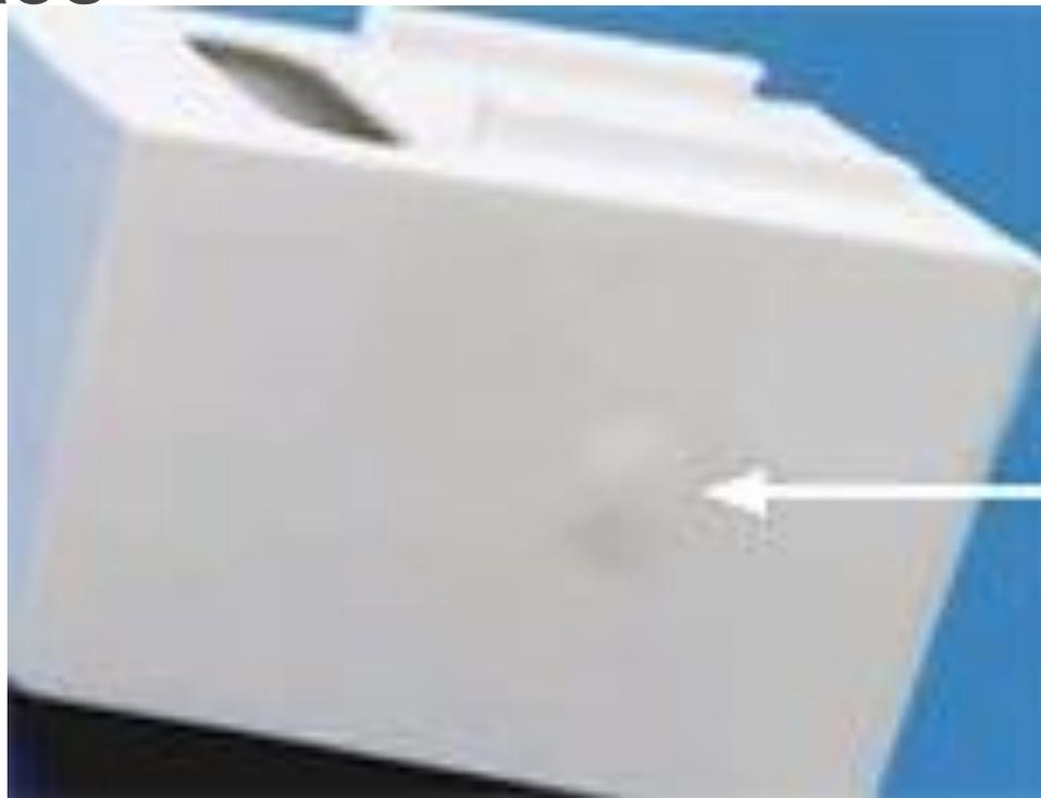
Воздух, попавший в расплав при впрыске, виден как полость (пузырек воздуха) на отлитой детали.
