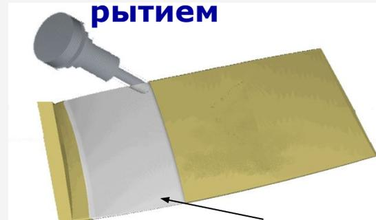
Наноструктурированные покрытия повышают износостойкость инструмента, что позволяет производить обработку металлов на более высоких скоростях и увеличивает срок службы инструмента
