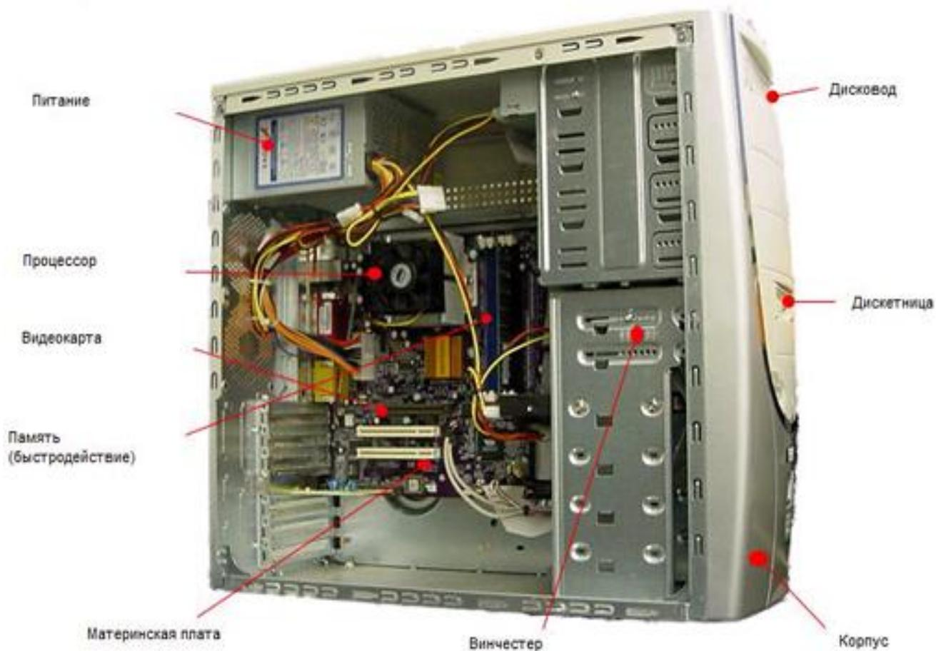
Системный блок – основной блок компьютерной системы
