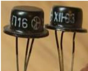
Элементная база – полупроводниковые приборы – транзисторы и тиристоры.
