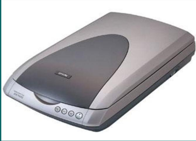
Предназначен для оптического ввода в компьютер и преобразование в цифровую форму изображений (фотографий, рисунков, слайдов), а так же текстовых документов
